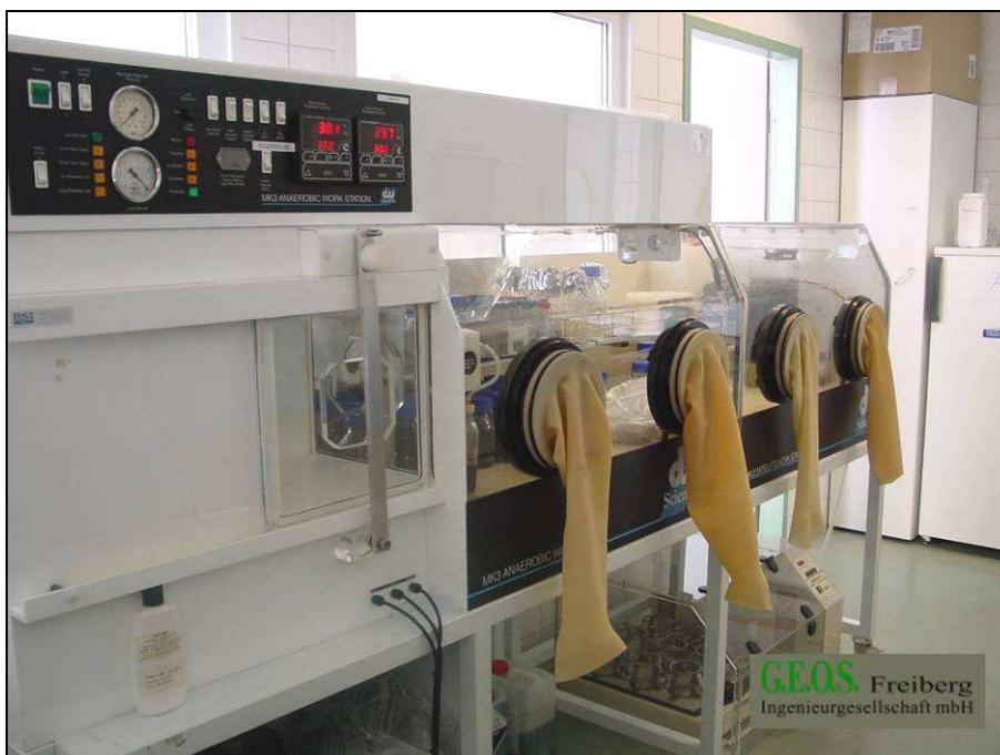
Abbildung 8: Anaerobbox zur Durchführung von Versuchen unter Sauerstoffausschluss
