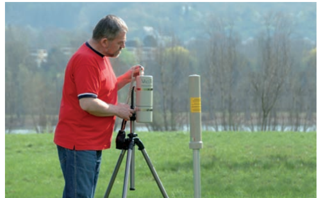
Die fest installierte ODL-Messstelle und das mobile TRADOS-Handmessgerät dienen beide der Erfassung der Gammaortsdosisleistung (ODL).
