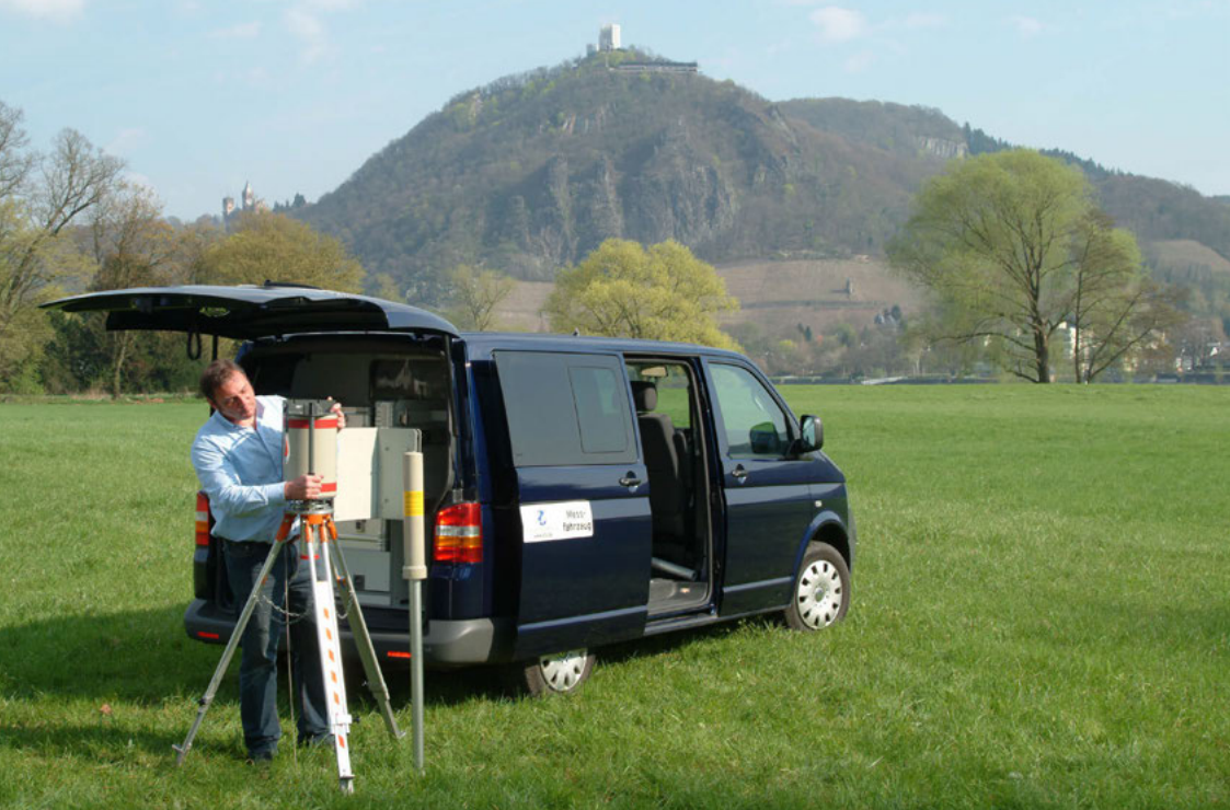
Mobile in-situ Messung an einer ODL-Messstelle
