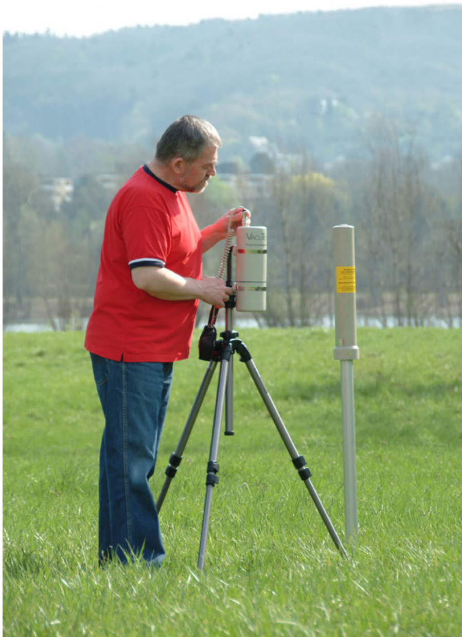
Die ortsfeste ODL-Messstelle und das mobile TRADOS-Handmessgerät erfassen die Gammaortsdosisleistung (ODL).
