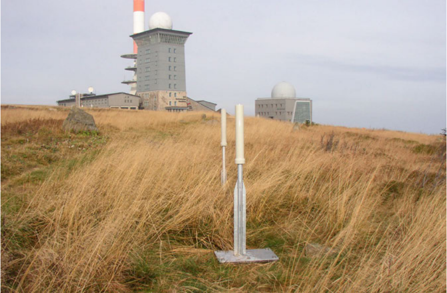
Versuchsmessstelle auf dem Brocken mit spektroskopischer CZT-Sonde (im Vordergrund) und normaler ODL-Sonde dahinter
