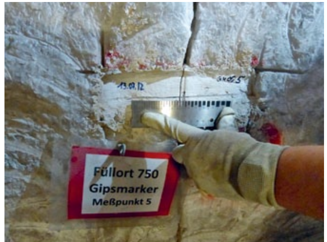
Millimetergenaues Wissen: Sogenannte Gipsmarker geben Auskunft über feinste Veränderungen von Rissen im Bergwerk
