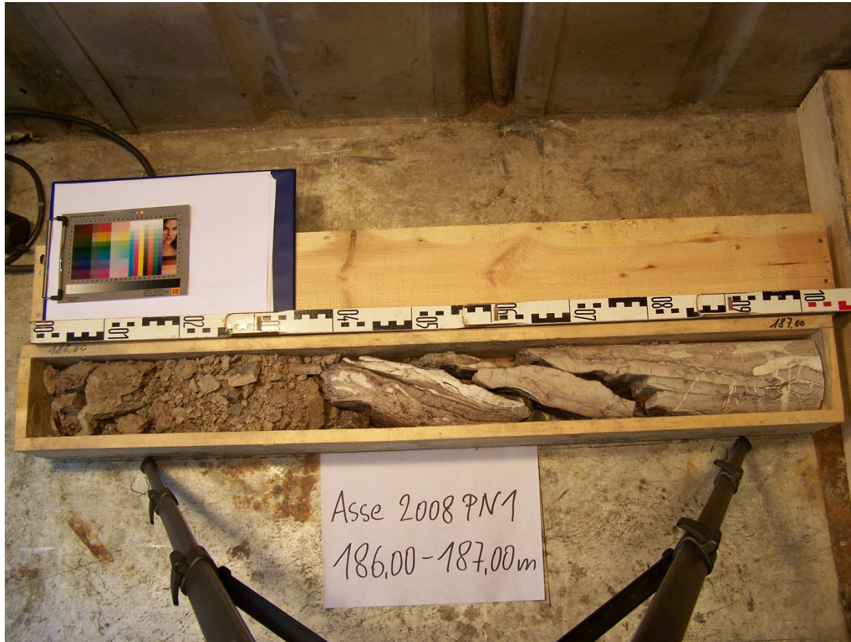
Wasserführende Störungszone, Bohrung PN1 (Oberkante Röt 4)
