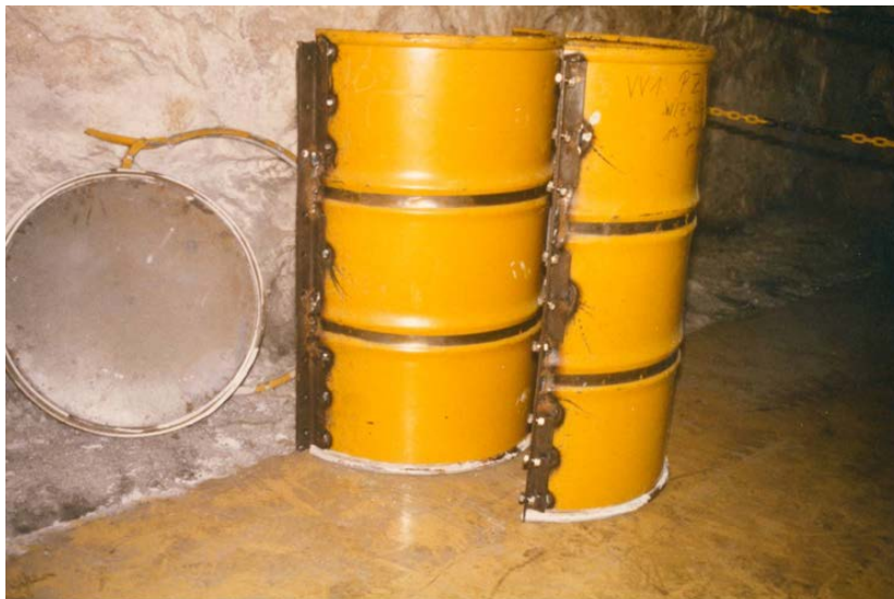
Abb. 3 Aufnahme des Schalungsgefäßes zur Herstellung der Probekörper #20 bis #36.
