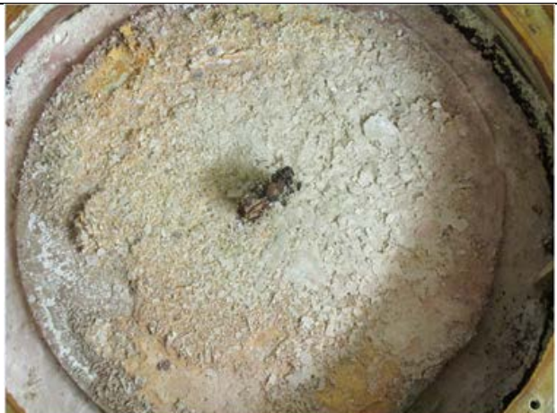
Probekörper #35 nach 25.3 Jahren Auslaugung in NaCl-Lösung
