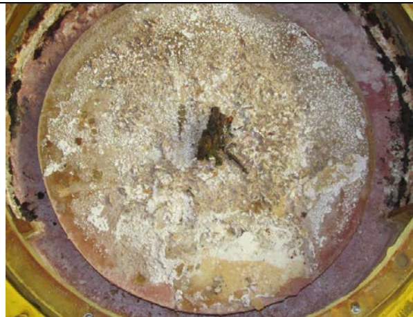
Probekörper #32 nach 26.7 Jahren Auslaugung in NaCl-Lösung
