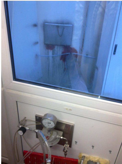
Abbildung A3: Ansicht der Verbindung zwischen dem Probeentnahmerechen im Diffusor und der Aerosol-Sammeleinrichtung QM-S2 im Messcontainer
