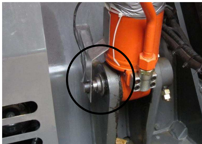
Abbildung 20: Winkelpotentiometer des Herstellers Megatron Elektronik GmbH & Co. KG vom Typ MP20 am Trägergerät.
