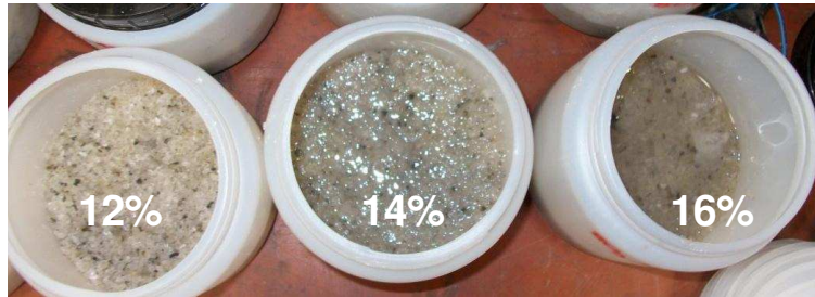
Abbildung 1: Untersuchung der Auswirkung des Wasseranteils auf die Verfestigung von Salzgrus.
