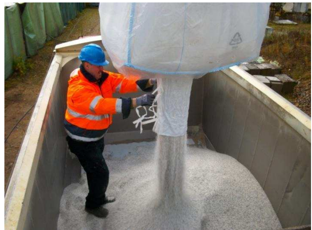
Abbildung 14: Befüllen des Transmixes mit Steinsalz.
