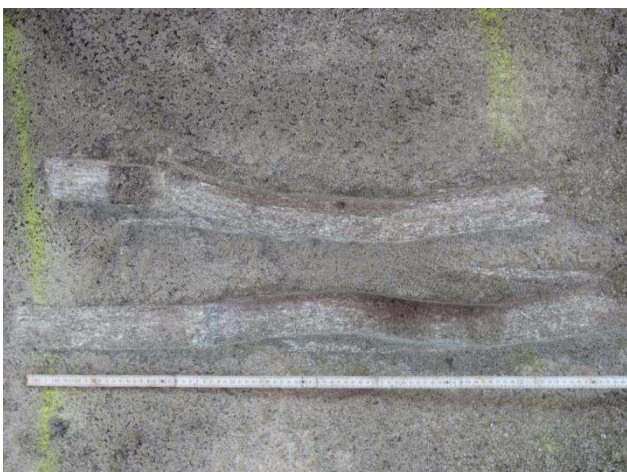
Abbildung 37: Schürfspuren des Reißzahns im Steinsalzbeton.
