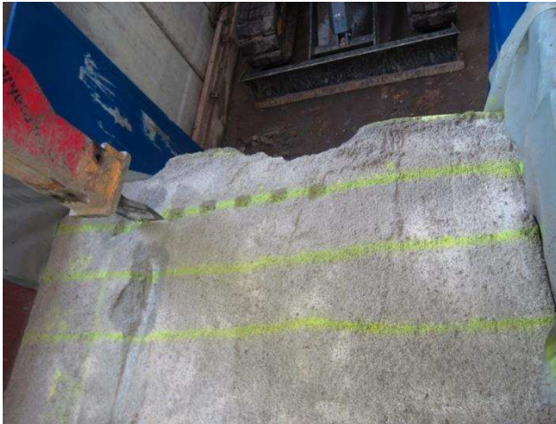
Abbildung 61: Flachmeißel am Steinsalzbetonblock, 30 cm zur Abbruchkante.
