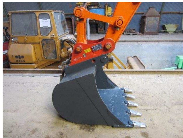
Abbildung 21: Eingesetzter Baggerlöffel des Herstellers Lehnhoff Hartstahl GmbH & Co. KG vom Typ CTL5.
