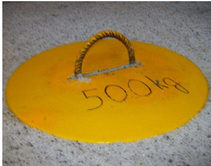
Abbildung 98: Für Zugversuche stehend eingebautes Gebinde.
