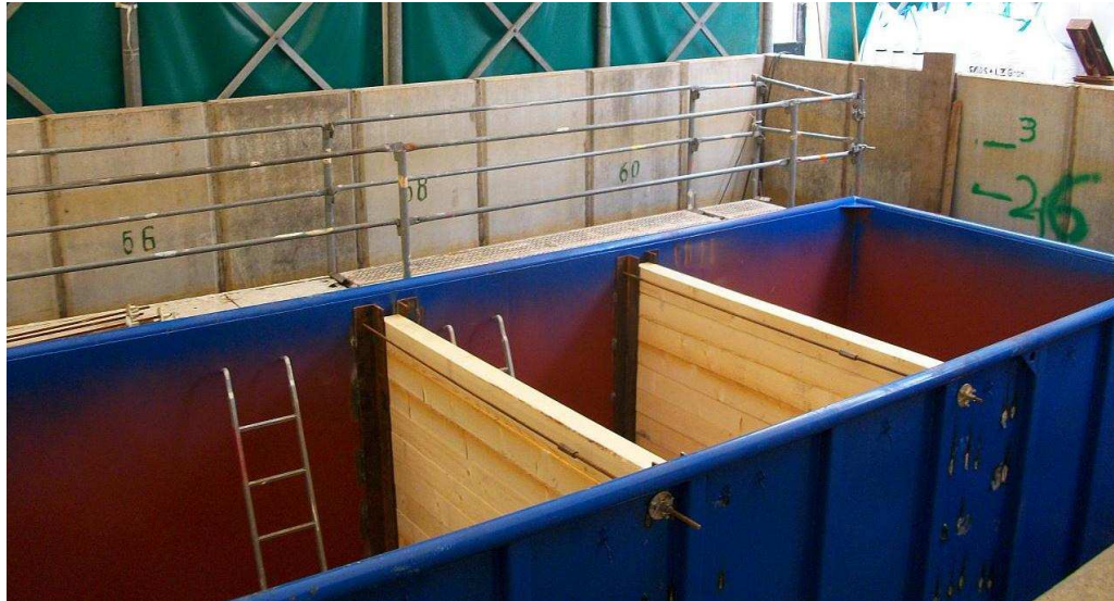
Abbildung 85: Versuchcontainer mit Kammerabtrennung für Löseversuche.
