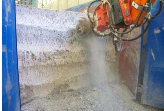
Abbildung 48: Fräsversuch am Steinsalzbeton.
