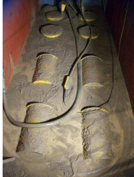
Abbildung 12: Versuchscontainer mit aufgelagerten Gebinden während der Betonage.
