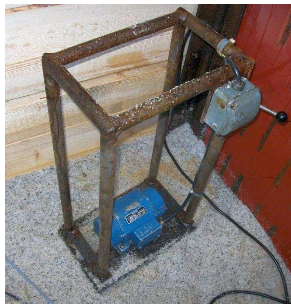
Abbildung 96: Zur Salzverdichtung eingesetzte Rüttelplatte .
