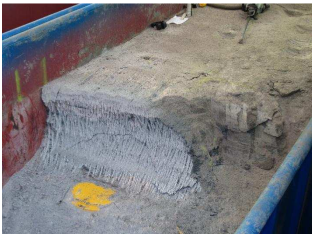
Abbildung 82: Verlauf der durch den Spaltversuch erzeugten Bruchkanten des Steinsalzbetons.
