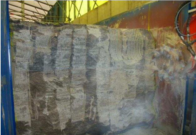
Abbildung 47: Steinsalzbetonblock vor dem Fräsen.
