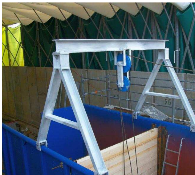
Abbildung 86: A-Bock auf Versuchcontainer für die Löseversuche positioniert.
