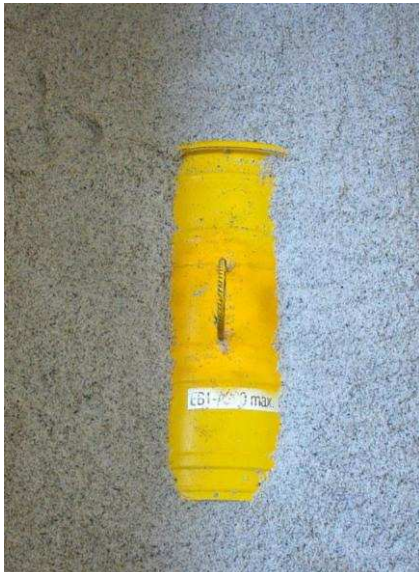
Abbildung 97: Für Zugversuche liegend eingebautes Gebinde.
