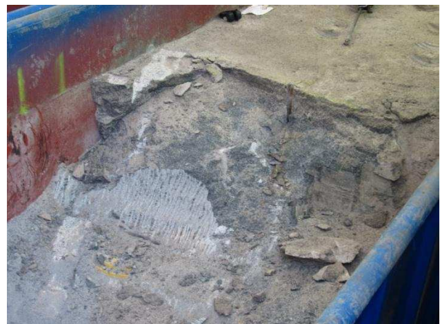
Abbildung 83: Durch den Spaltversuch erzeugter Gesamtabbruch aus dem Steinsalzbeton.
