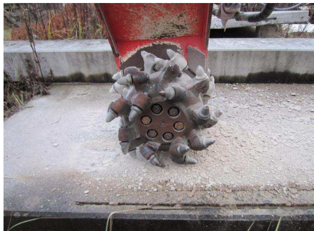
Abbildung 40: Eingesetzte Fräse mit Querschneidkopf des Herstellers Simex s.r.l. vom Typ TF400.
