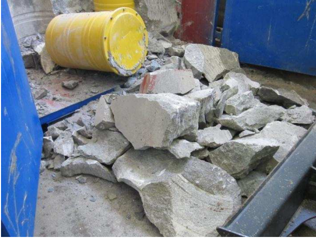
Abbildung 67: Durch Flachmeißelversuch erzeugte Bruchstücke aus Steinsalzbeton.
