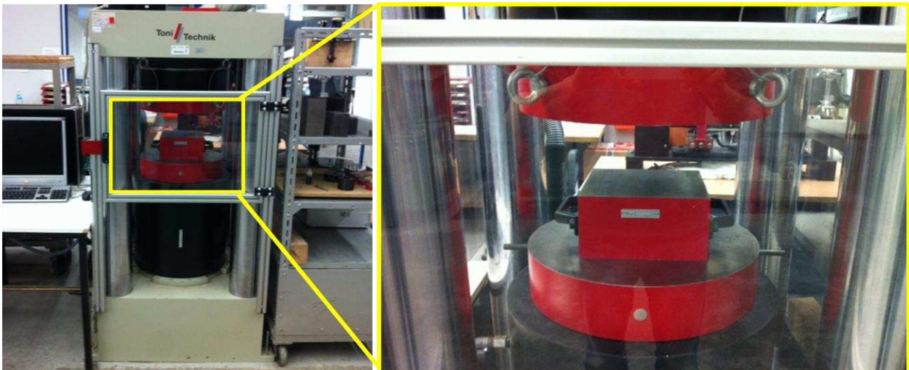
Abbildung 3: Prüfgerät zur Untersuchung der Druckfestigkeit, Hersteller Toni Technik Baustoffprüfssysteme GmbH, Typ 2031.
