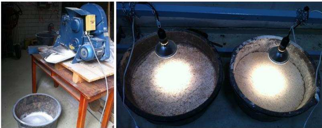
Abbildung 2: Eingesetzter Backenbrecher zum Zermahlen von Salzgrus (links), Wärmelampen zum Beschleunigen des Verfestigungsvorgangs von Salzgrus (rechts).
