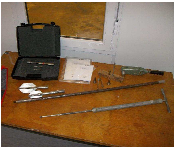
Abbildung 93: Eingesetzte Flügelsonde inklusive Zubehör.
