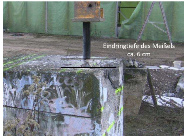
Abbildung 60: Eindringtiefe des Spitzmeißels im Beton.
