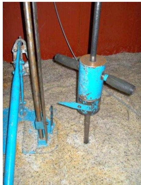
Abbildung 94: Rammsonde beim Einsatz.
