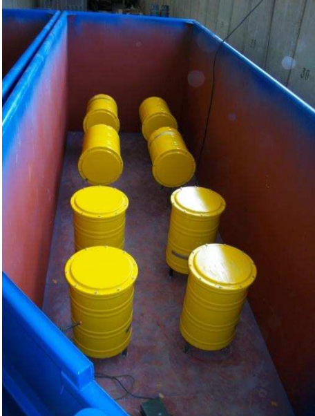
Abbildung 11: Versuchscontainer mit aufgelagerten Gebinden vor der Betonage.
