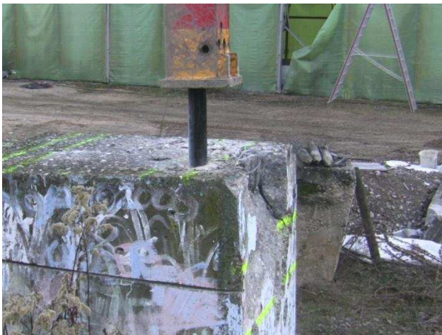
Abbildung 59: Meißelversuch mit dem Spitzmeißel am Beton.
