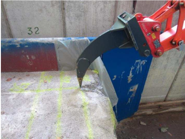
Abbildung 33: Scherversuch am Steinsalzbeton mit dem Reißzahn.
