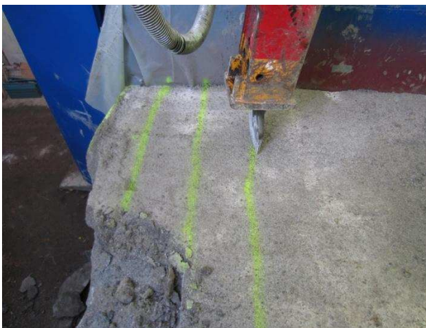
Abbildung 63: Flachmeißel am Steinsalzbetonblock, 90 cm zur Abbruchkante.
