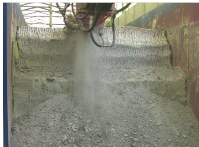
Abbildung 54: Staubentwicklung beim Fräsen in Steinsalzbeton.
