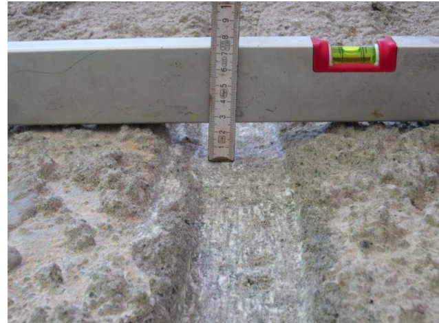
Abbildung 29: Eindringtiefe der Löffelzähne im Steinsalzbeton.
