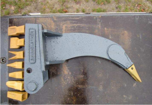
Abbildung 30: Eingesetzter Reißzahn des Herstellers Baumgärtner Stahlbau GmbH.
