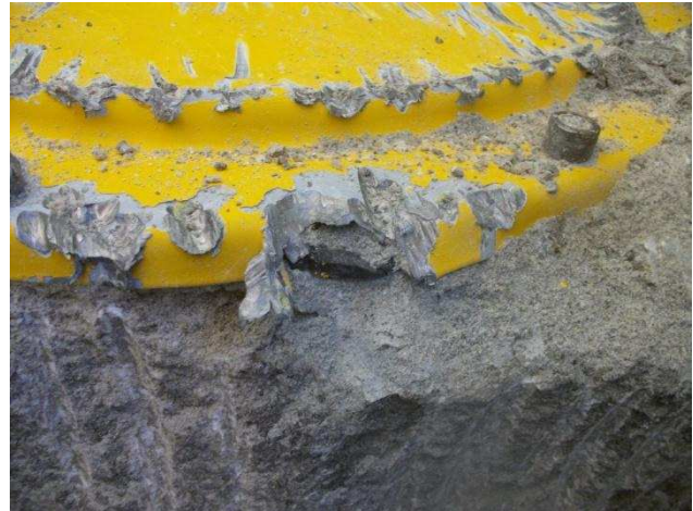
Abbildung 52: Beschädigungen am Gebindedeckel.
