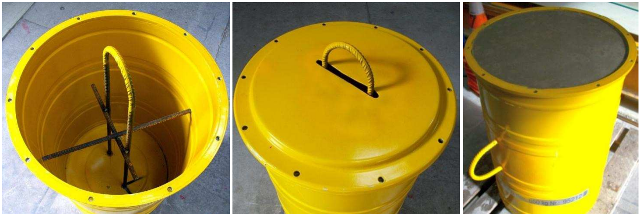
Abbildung 89: Vorbereitung der Gebinde für die Zugversuche.
