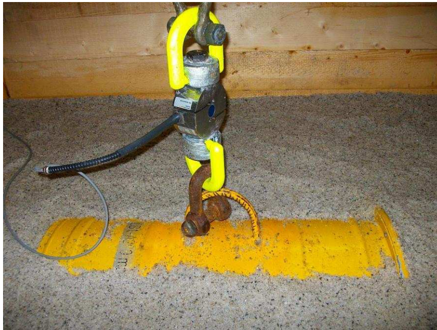
Abbildung 92: Kraftsensor über Lastösen am Gebinde fixiert.
