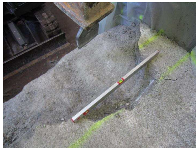
Abbildung 64: Mit Flachmeißel erzeugter Ausbruch aus dem Steinsalzbetonblock.
