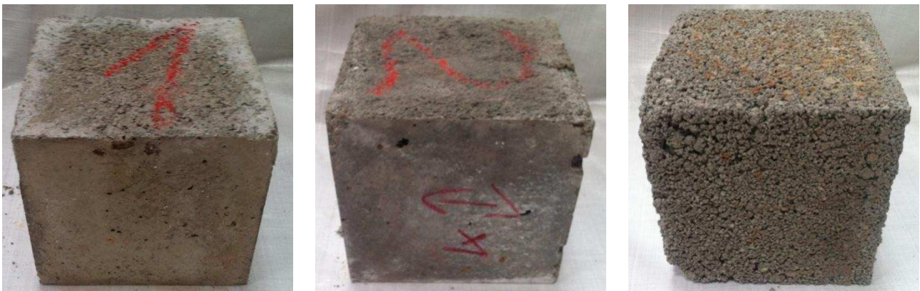
Abbildung 4: Prüfwürfel aus Steinsalzbeton der Mischungen M1, M2 und M3 (v. l. n. r.).
