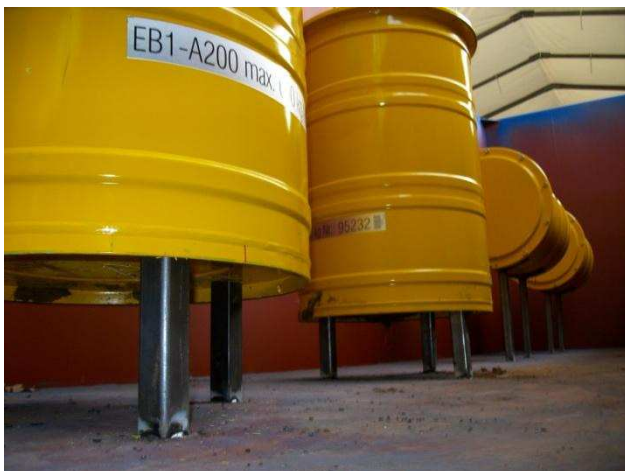
Abbildung 9: Auflagerungssituation der stehenden Gebinde im Versuchscontainer.
