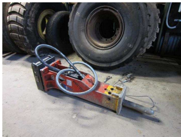
Abbildung 55: Eingesetzter Hydraulikmeißel der Firma İnan Makina Sanayi ve Ticaret A.Ş. Typ MTB 40.
