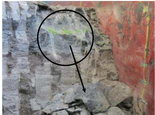
Abbildung 66: Mit Spitzmeißel erzeugter Abtrag aus dem Steinsalzbetonblock.
