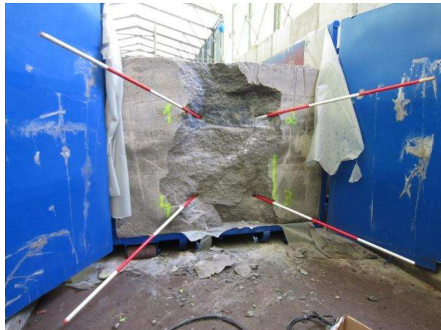
Abbildung 78: Abtragsergebnis des Spaltgeräts nach dem vierten Spaltvorgang.
