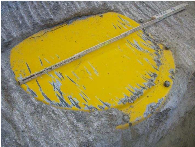
Abbildung 51: Frässpuren auf dem Gebindedeckel.
