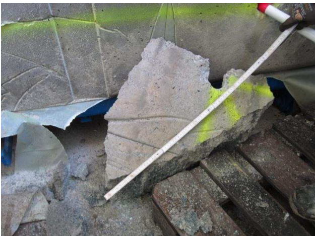
Abbildung 75: Durch den zweiten Spaltvorgang erzeugtes Bruchstück aus dem Steinsalzbeton.
