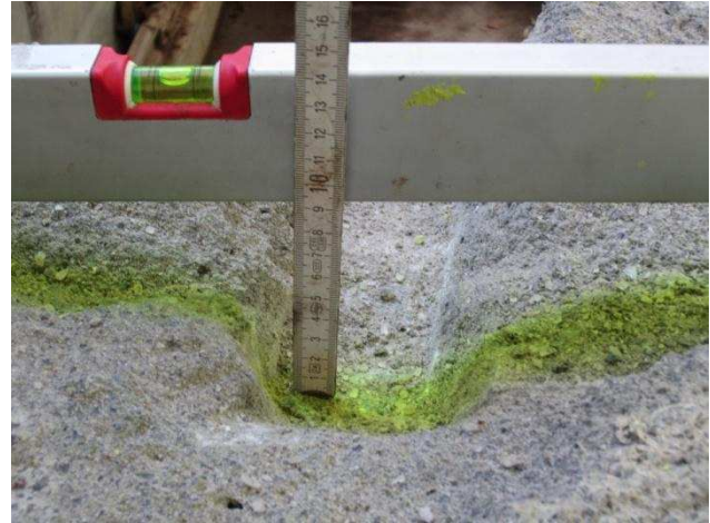
Abbildung 34: Eindringtiefe im Steinsalzbeton bei schlagender Bearbeitung.
