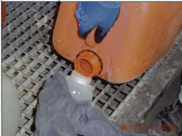
Foto 39: Beprobung Batteriesäure (A58-2012)
