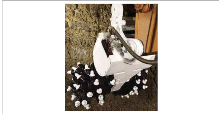
Abbildung 25: Hydraulische Anbaufräse am Baggerausleger [29]
