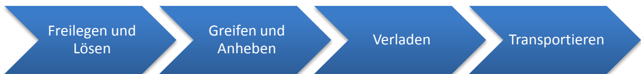
Abbildung 7: Verfahrenstechnische Kette für die Rückholung
