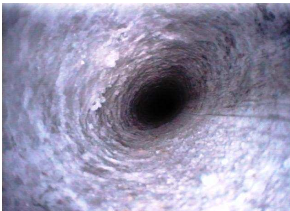
Foto 2d: Beanspruchter Bereich / elliptisch bei 40,25 m
