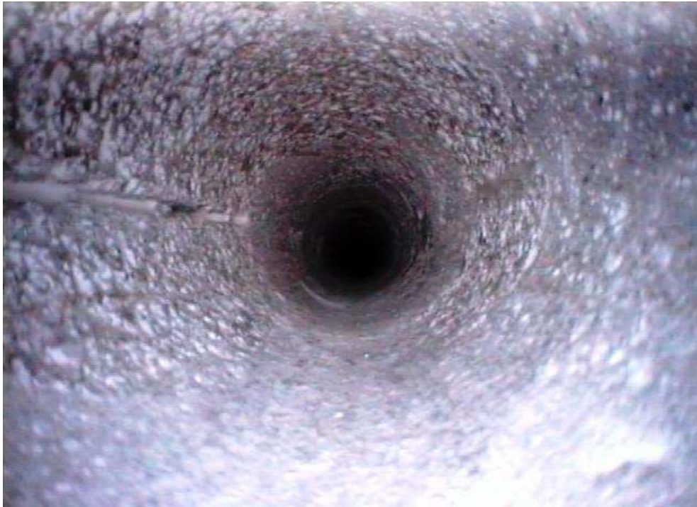
Foto 3a: Riss östliche Bohrlochwand bei 1,64 m
