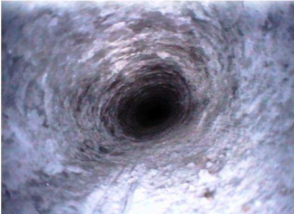
Foto 11a: Bohrloch konvergiert ab 14,00 m auf <70 mm, Bohrlochwand porös und elliptisch
