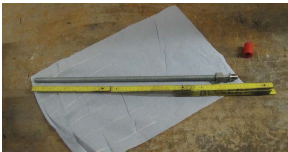
Abbildung 2.4: Konvergenzbolzen für Konvergenz-Messgerät BGKM 30 (Sohle)
