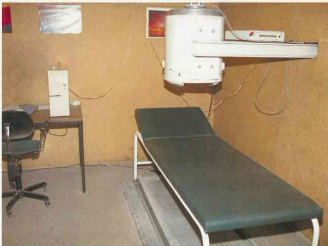
Abbildung 8 Ganzkörperzähler-Messraum auf der 490-m-Sohle
