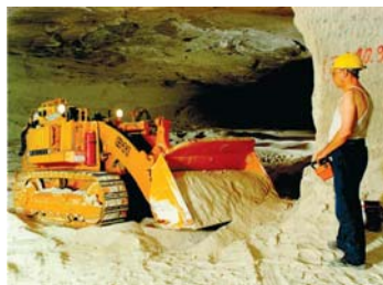
Mit einer fernbedienten Raupe kann bereits eingebrachtes Versatzmaterial verdichtet werden.
