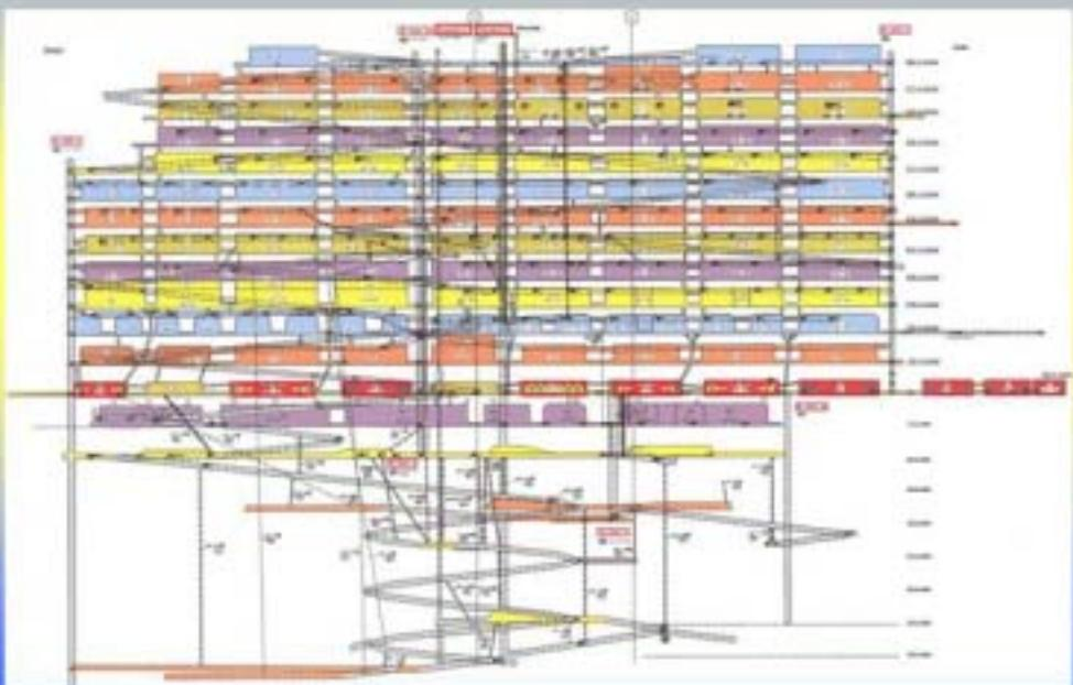
Wenn wir von Süden auf das Grubengebäude schauen, erhalten wir entsprechend Schnitt 1 des Risswerks diese Darstellung. Da sehen Sie nun das Abbausystem der Südflanke dargestellt, hier die Abbaukammern, in vertikaler Richtung die Pfeiler und in horizontaler Richtung die Schweben. Das sind die Tragelemente, die dem ganzen Baufeld Stabilität verleihen.
