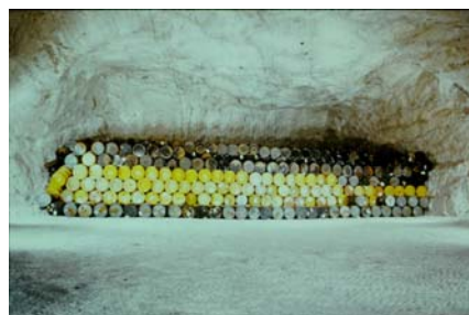
Abb. 1: Einlagerung von schwachradioaktiven Abfällen (Stapeltechnik)
