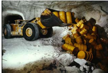
Abb. 2: Einlagerung schwachradioaktiver Abfälle (Abkipptechnik)
