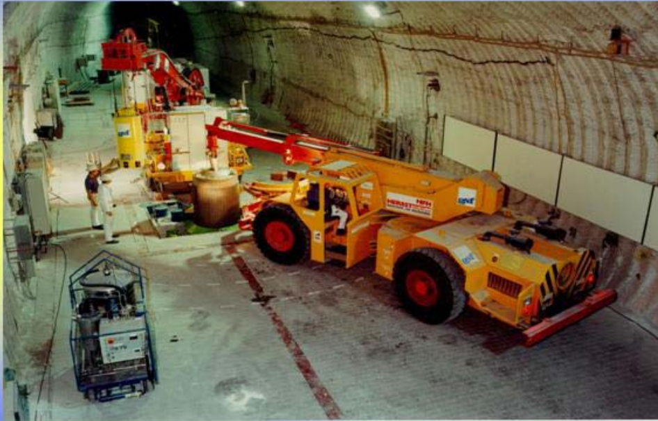
Demonstrationseinlagerung hochradioaktiver Versuchsquellen (Kalterprobung)
