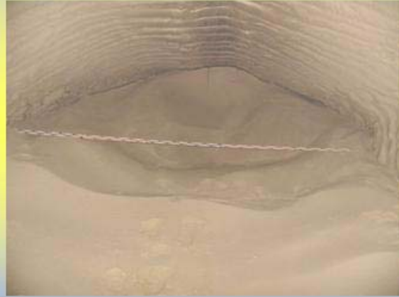
Blick in eine zu verfüllende Laugensumpfstrecke auf der 975-m-Sohle
