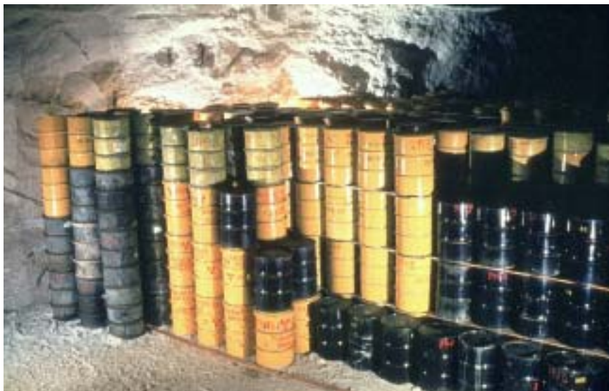
Foto 1: Stapeltechnik im Abbau 4 der 750-m-Sohle, Fässer stehend
