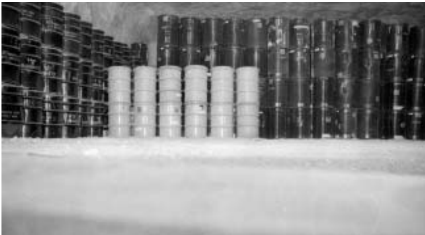
Foto 3: Stapeltechnik im Abbau 4 der 750-m-Sohle, Fässer stehend
