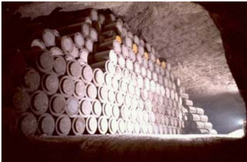
Foto 6: Stapeltechnik, Verlorene Betonab- schirmungen liegend
