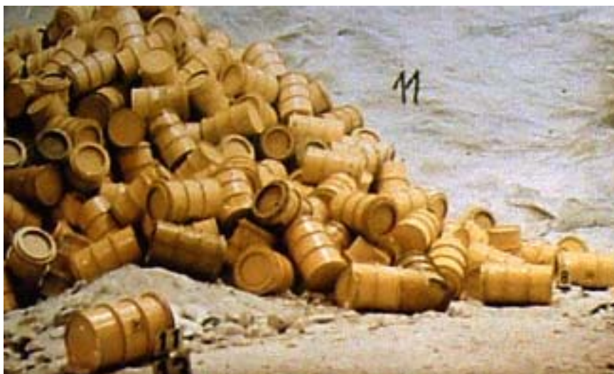
Foto 13: MAW - Einlagerungs- kammer 8a, 511-m-Sohle, Fasskegel
