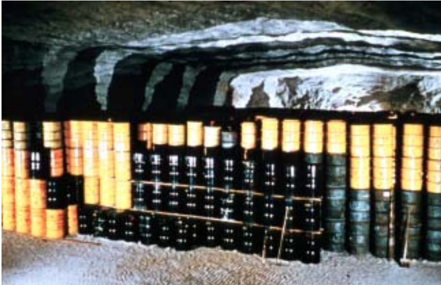
Foto 2: Stapeltechnik im Abbau 4 der 750-m-Sohle, Fässer stehend
