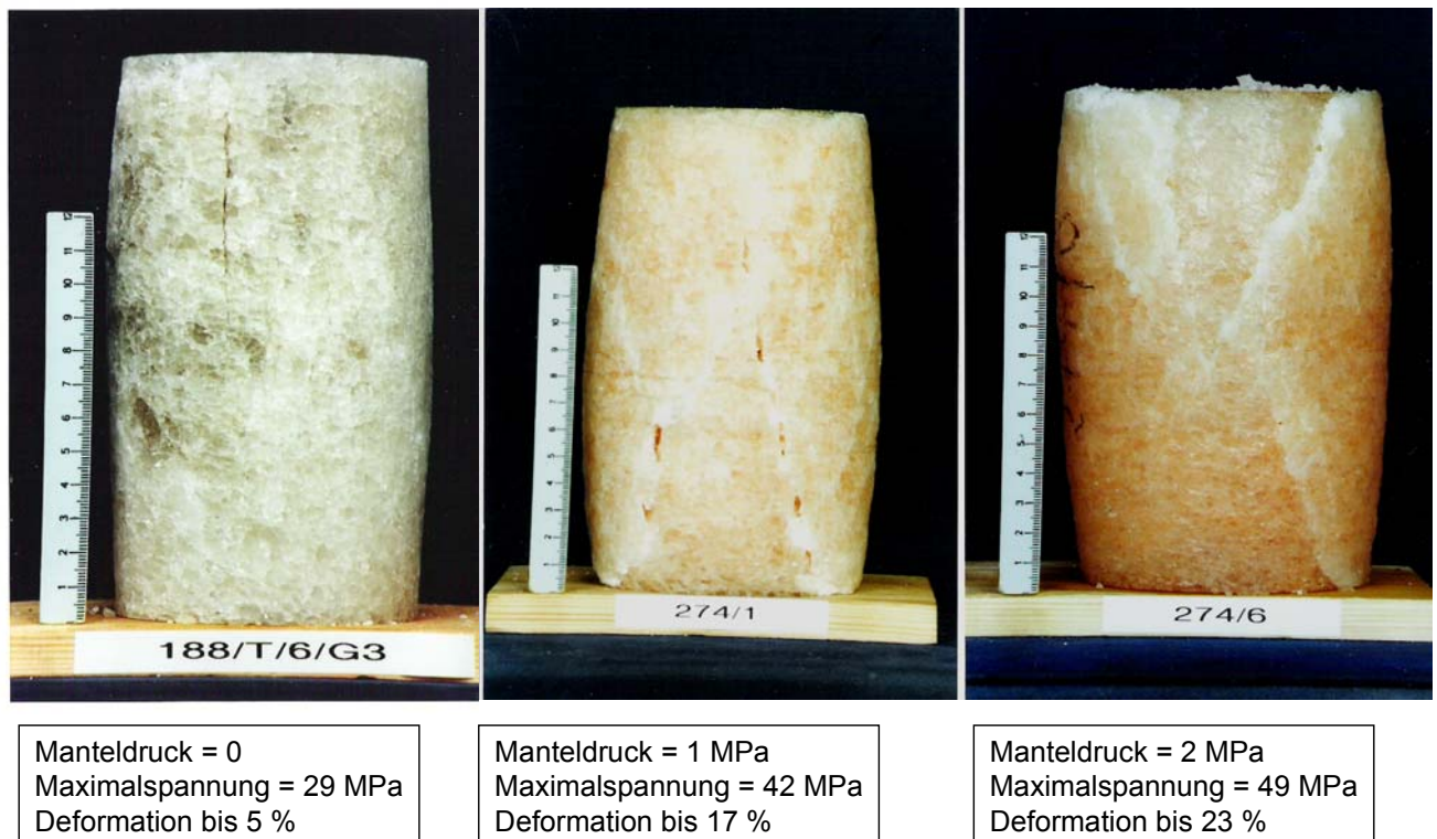
Bild 8: Prüfkörper Steinsalz Asse nach den Festigkeitsversuchen
