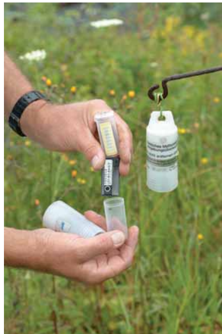
Einrichtung eines Messplatzes zur Bestimmung der Ortsdosis in der Umgebung
