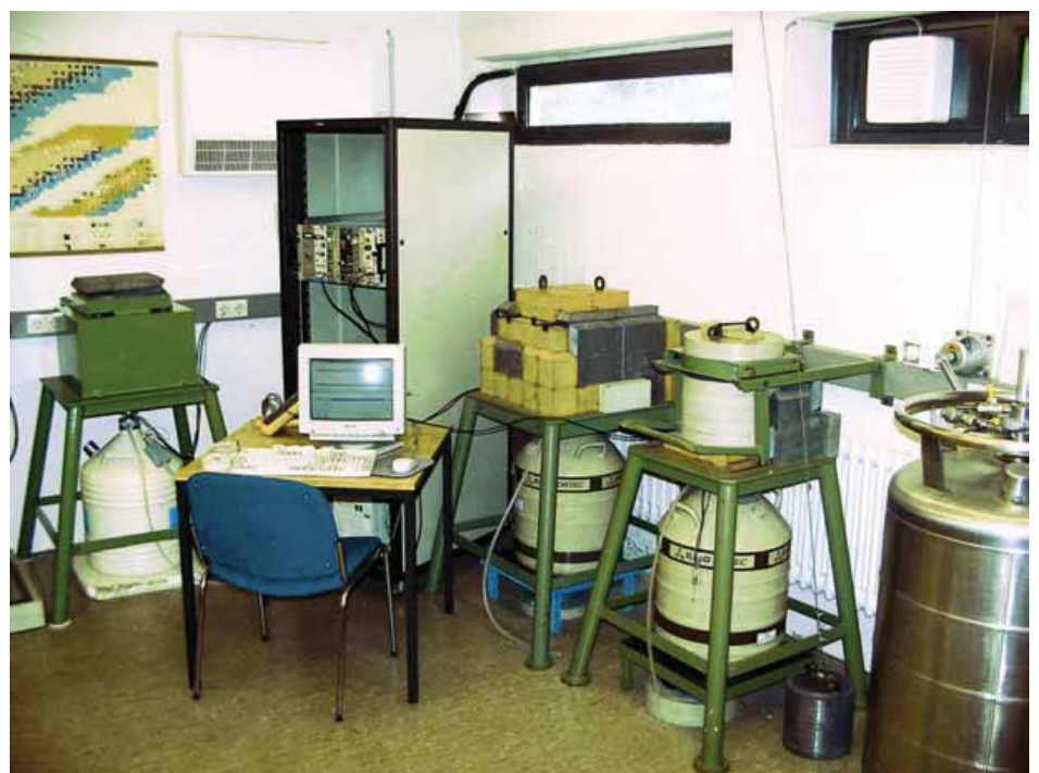
Gammastrahlungsmessplätze zur Bestimmung niedriger Aktivitäten
