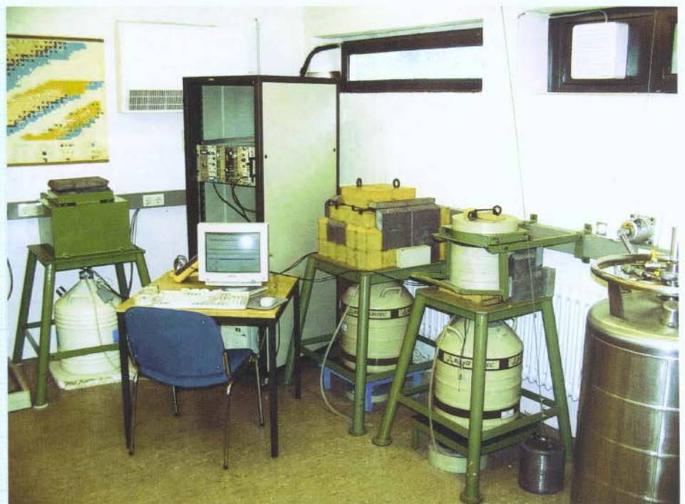
Gammaskpektrometrische Messplätze zur Bestimmung niedriger Aktivitäten
