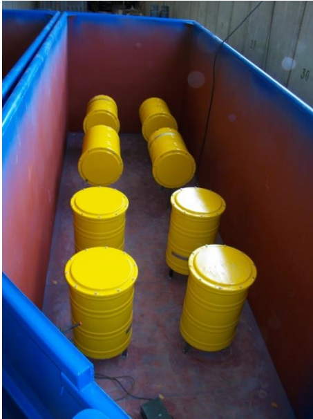
Abbildung 2: Versuchsstand mit aufgelagerten Gebinden vor (links) und während (rechts) der Betonage.
