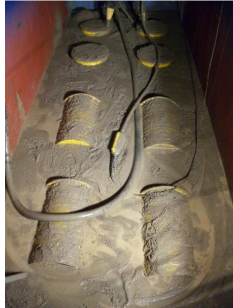
Abbildung 2: Versuchsstand mit aufgelagerten Gebinden vor (links) und während (rechts) der Betonage.
