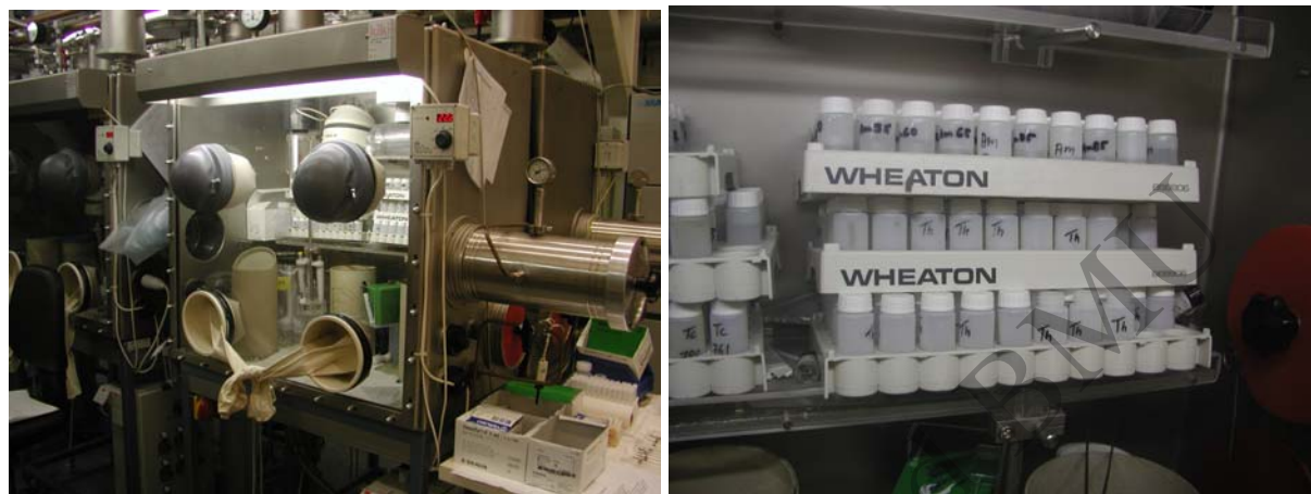
Abbildung 16: Inertgashandschuhkasten mit Batchexperimenten, die im Rahmen des Experimentellen Programms durchgeführt werden.
