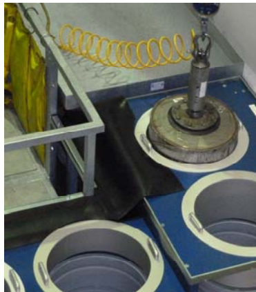
Bild 2: Verpacken der Presslinge in Fässer
